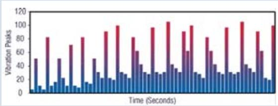
FIGURE 9 – NOISE RECORDING ON A “DIRTY” GREASE
